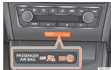
Şek. 30 Gösterge panelinin ortası: orta konsolda devre dışı bırakılmış ön yolcu hava yastığının kontrol lambası.
