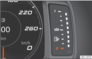
Şek. 61 Dijital gösterge paneli: yakıt gösterge- si.
