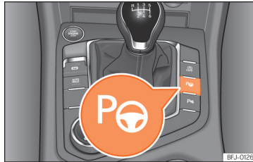
Şek. 202 Orta konsolun üst kısmında: Park Assist sistemini açma düğmesi
