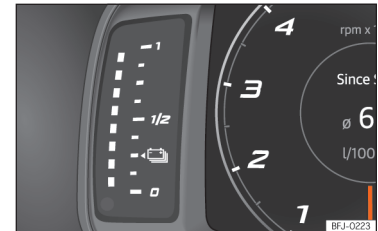
Şek. 60 Gösterge paneli: akü seviyesi göstergesi.
