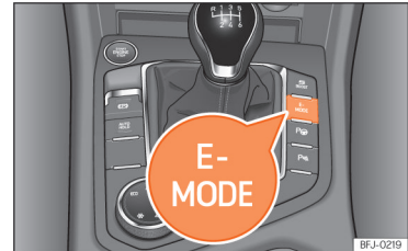
Şek. 166 Orta konsol: E-MODE düğmesi.
