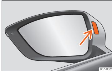
Şek. 195 Şeritten çıkma uyarısının kontrol lambası.
