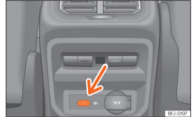
Şek. 163 Orta konsolun arka kısmı: Güç çıkışı fonksiyonlu USB konektörleri.
