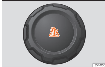
Şek. 248 Motor bölmesi: soğutma suyu genişleme deposu kapağı.
