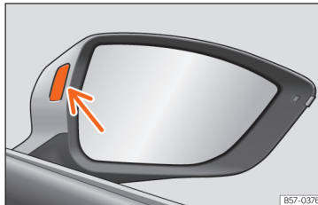
Şek. 196 Şeritten çıkma uyarısının kontrol lambası.
