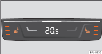
Şek. 151 Orta konsolun arka kısmında: arka koltuk ısıtma anahtarı.
