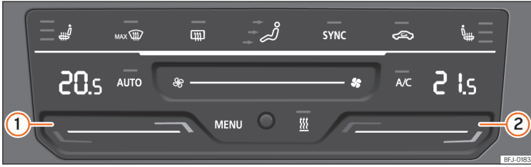
Şek. 147 Orta konsolda: Climatronic düğmeleri.
