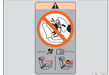
Şek. 25 Hava yastığı çıkartması: yolcu tarafı kapısının arka çerçevesinde
