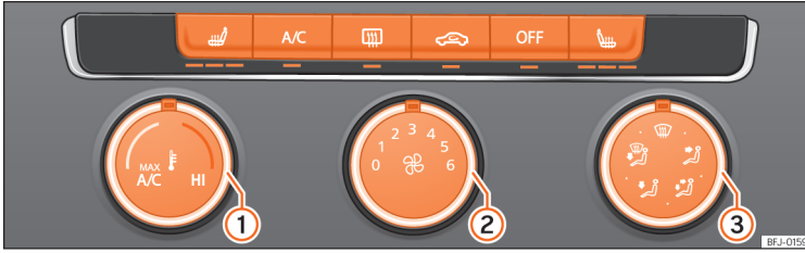
Şek. 148 Orta konsolda: manuel klima düğmeleri.
