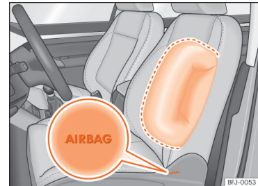
Şek. 21 Sürücü koltuğundaki yan hava yastığı. »
