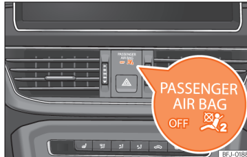
Şek. 18 Gösterge paneli: ön yolcu ön hava yastığının devre dışı bırakılması için kontrol lambası.
