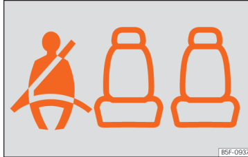
Şek. 6 Gösterge paneli: sol arka koltuk dolu ve ilgili koltuk kemeri takılı ekranı.
