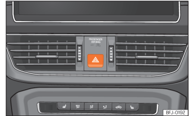
Şek. 96 Gösterge paneli: dörtlü flaşör lambaları anahtarı
