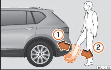
Şek. 87 Sensör kontrollü açılan bagaj kapağı (Easy Open)
