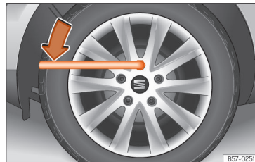
Şek. 35 Tekerlek değişimi: bijon somunlarının gevşetilmesi.
