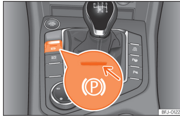
Şek. 200 Orta konsolun alt kısmında: elektronik park freni düğmesi
