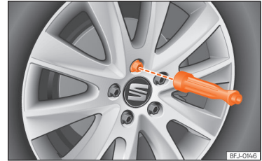
Şek. 39 Tekerlek değişimi: tornavidanın sapındaki soket ile tekerlek somunlarını gevşetin.
