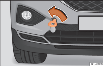
Şek. 46 Ön tamponun sağ tarafında: çekme bağlantısı konumu
