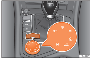
Şek. 173 Orta konsol: Driving Experience düğmesi.
