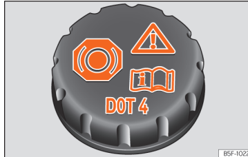
Şek. 249 Motor bölmesi: fren hidrolik haznesi kapağı.
