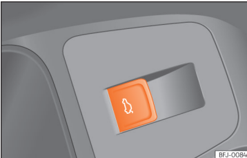
Şek. 86 Sürücü kapısında: bagaj kapağını açma ve kapatma düğmesi.
