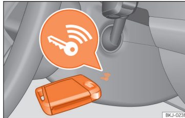
Şek. 165 Direksiyon kolunun sağında: acil durumda çalıştırma.
