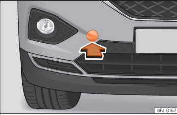
Şek. 45 Ön tamponun sağ tarafında: kapağı çıkarın.
