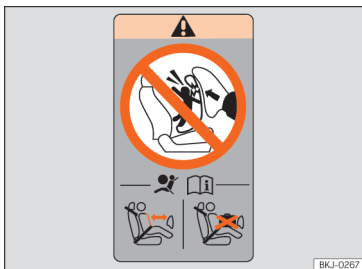
Şek. 23 Hava yastığı çıkartması: yolcu tarafı kapisının arka çerçevesinde
