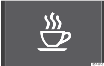
Şek. 63 Gösterge paneli ekranında: sürücü ikaz sistemi sembolü.
