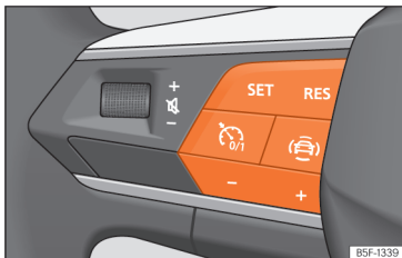
Şek. 149 Çok fonksiyonlu direksiyon simidinde: hız sınırlayıcıyı kullanmak için gereken düğmeler.
