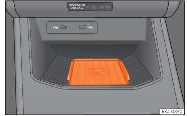
Şek. 130 Orta konsolda: cep telefonu bağlantısı için ped.
