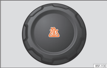
Şek. 193 Motor bölümü: soğutma suyu genişleme deposu kapağı.
