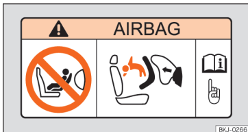
Şek. 22 Hava yastığı çıkartması: yolcunun güneş siperliği üzerinde
