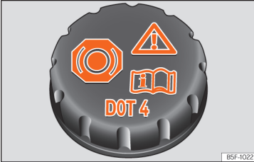
Şek. 194 Motor bölmesi: fren hidrolik haznesi kapağı.
