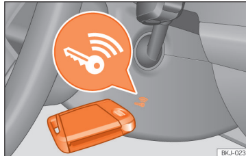
Şek. 134 Direksiyon kolunun yanında: acil durumda çalıştırma.
