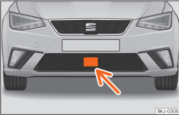
Şek. 142 Ön tampondaki radar sensörleri.
