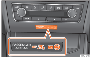
Şek. 17 Gösterge tablosunun orta kısmı: ön yolcu ön hava yastığının devre dışı bırakılması için kontrol lambası.
