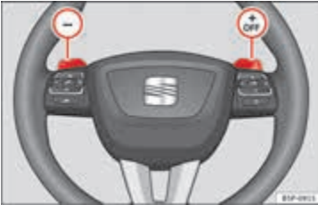
Şek. 129 Otomatik şanzıman için kumanda kolları bulunan direksiyon simidi.
