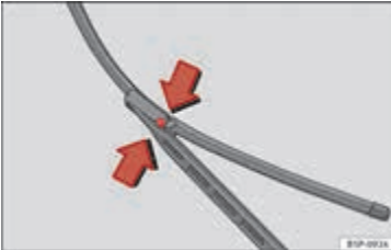
Şek. 170 Ön cam silecek lastiklerinin değiştirilmesi
