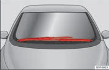
Şek. 169 Ön cam silecekleri servis pozisyonunda.
