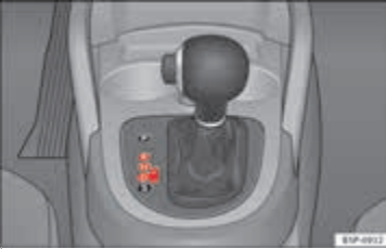
Şek. 126 Orta konsol: otomatik şanzıman vites kolu.
