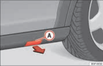
Şek. 160 Kriko ankraj kapaklı plastik eşik paneli kaplaması
