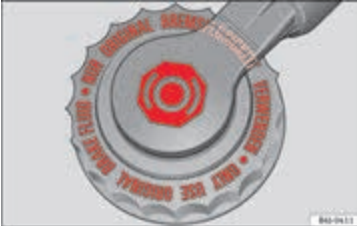
Şek. 151 Motor bölümü: fren hidrolik haznesi kapağı
