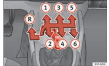
Şek. 124 Orta konsolun ayrıntılı görünümü: 5 veya 6 vitesli manuel şanzımanda vites değiştirme şekli.
