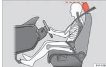
Şek. 2 Sürücü için doğru baş desteği konumu.
