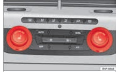
Şek. 78 Climatronic ile ön koltuk ısıtma.
