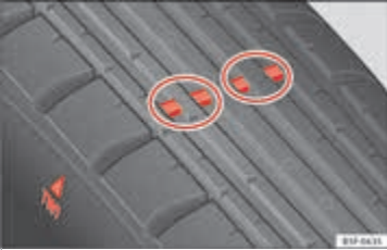
Şek. 152 Lastik sırt aşınma göstergeleri.
