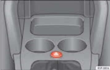
Şek. 63 Ön göğüs: dörtlü flaşör lambaları anahtarı.
