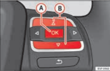
Şek. 40 Direksiyondaki kumandalar: kontrol düğmeleri.
