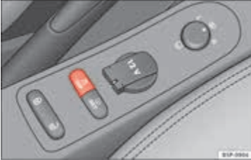
Şek. 131 Orta konsolun ayrıntılı görünümü: ESC anahtarı.
