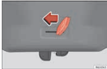
Şek. 168 Bagaj kapağı: acil durumda açma.
