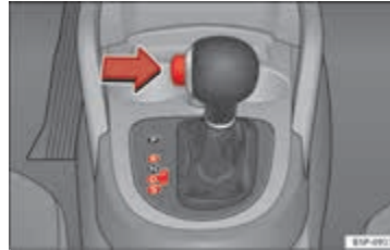
Şek. 127 Orta konsol: otomatik şanzıman vites kolu.
