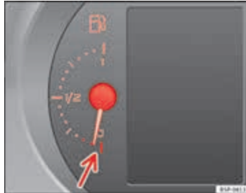
Şek. 27 Gösterge paneli: yakıt göstergesi
