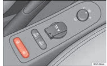
Şek. 47 Orta konsolun ayrıntılı görünümü: merkezi kilit düğmesi.
