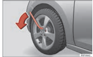
Şek. 157 Tekerleğin değiştirilmesi: bijonları gevşetme.
