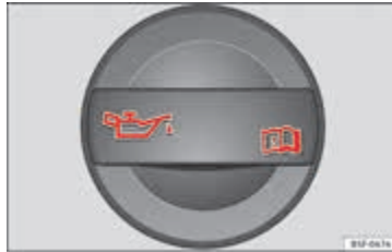
Şek. 148 Motor bölümünde: Motor yağ doldurma kapağı
