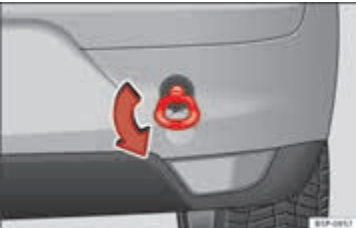
Şek. 166 Çekme bağlantısının aracın arkasına takılması.
