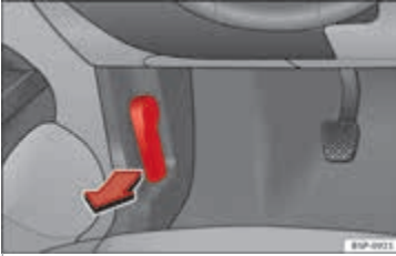
Şek. 144 Sürücü tarafındaki ayak bölmesi alanı detayları: kaputun kilidini açma kolu
