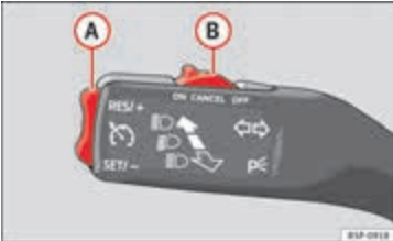
Şek. 135 Sinyal ve uzun far kolu: hız sabitleme düğmesi ve basmalı düğme.
