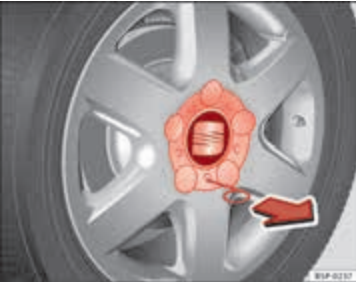
Şek. 155 Tekerleğin değiştirilmesi: jantı sökme.
