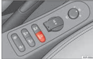
Şek. 121 Orta konsol: gaz sistemi kontrol düğmesi
