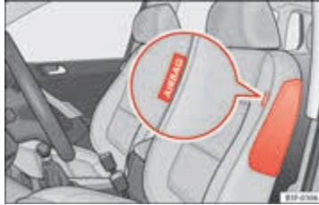
Şek. 15 Sürücü koltuğundaki yan hava yastığı.
