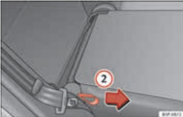
Şek. 82 Arka koltuk arkalıklarının kaldırılması.
