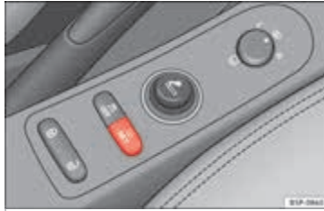
Şek. 32 Orta konsol: lastik izleme sistemi düğmesi.
