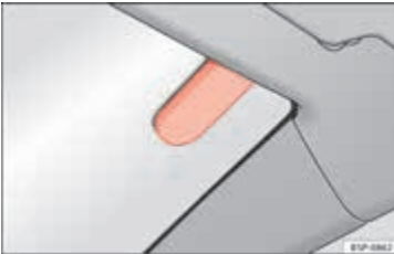
Şek. 70 Ön camdaki yağmur sensörünün araç içinden görünüşü.
