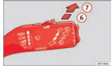
Şek. 71 Ön cam silecek kolu: arka cam sileceği.
