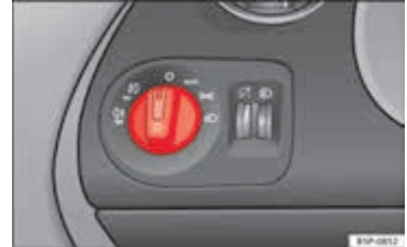
Şek. 58 Gösterge panelinin detaylı görünümü: lambalar, ön sis farları ve arka sis farı anahtarı.
