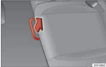
Şek. 79 Arka koltuktaki çubuğun kilidini açın
