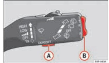
Şek. 36 Ön cam silecek kolu: kontrol düğmeleri.
