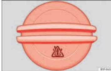
Şek. 149 Motor bölümü: soğutma suyu genleşme deposu kapağı.
