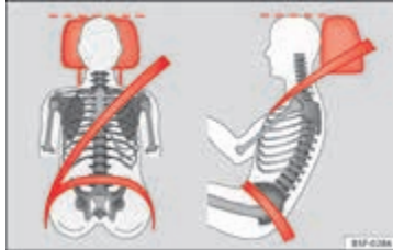
Şek. 75 Önden ve yandan görünüm: doğru şekilde ayarlanmış baş destekleri ve emniyet kemerleri.
