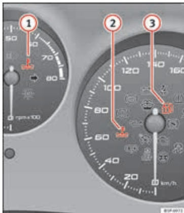
Şek. 31 LPG'li araçlarda gösterge paneli kumanda ve uyarı lambaları
