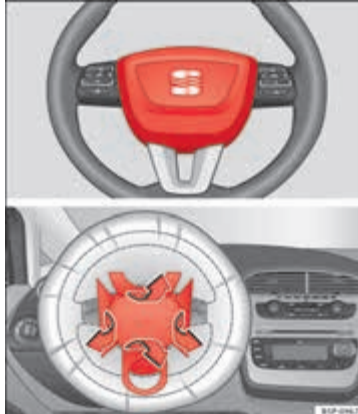
Şek. 13 Direksiyondaki sürücü hava yastığı ve gösterge panelindeki ön yolcu hava yastığı.
