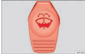
Şek. 150 Motor bölmesinde: Ön cam yıkama suyu deposu kapağı
