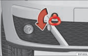
Şek. 165 Ön çekme hattı bağlantısının aracın ön kısmına takılması.
