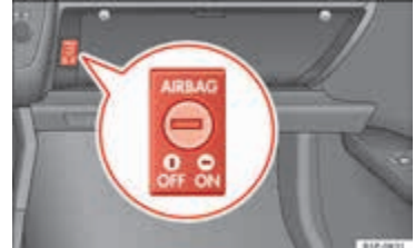
Şek. 19 Torpido gözünde: Ön yolcu hava yastığını etkinleştirme ve devreden çıkarma anahtarı.
