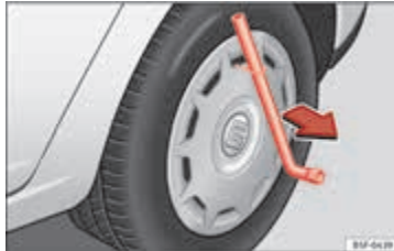
Şek. 156 Tekerleğin değiştirilmesi: jant kapağını sökme.
