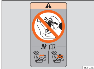
Şek. 23 Hava yastığı çıkartması: yolcu tarafı kapısının arka çerçevesinde
