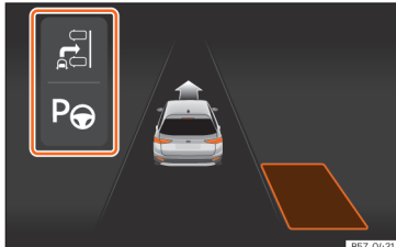
Şek. 170 Gösterge paneli ekranında: azaltılmış görüşlü park yardımı sisteminin görünümü.
