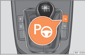
Şek. 169 Orta konsolda: park yardımı sisteminin açma düğmesi
