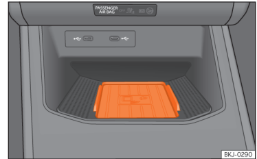
Şek. 133 Orta konsolda: cep telefonu bağlantısı için ped.
