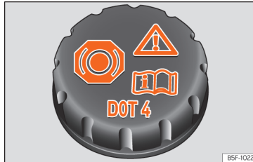
Şek. 203 Motor bölmesi: fren hidrolik haznesi kapağı.
