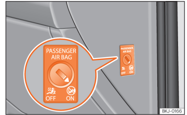
Şek. 16 Ön yolcu hava yastığını etkinleştirme ve devreden çıkarma anahtarı.
