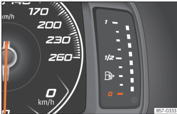
Şek. 70 Dijital gösterge paneli: yakıt göstergesi.
