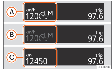
Şek. 153 Gösterge paneli ekranında: hız sınırlayıcı durumu göstergeleri.
