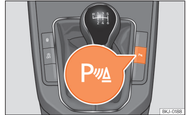
Şek. 176 Orta konsol: park yardımı düğmesi (sürüme bağlı olarak).
