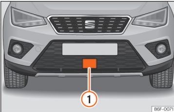
Şek. 145 Ön tamponda: radar sensörleri.
