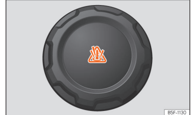
Şek. 202 Motor bölümü: soğutma suyu genleşme deposu kapağı.
