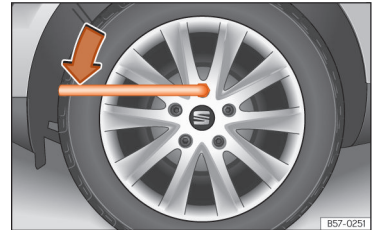
Şek. 35 Tekerlek değışimi: bijon somunlarının gevşetilmesi.
