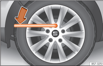
Şek. 43 Tekerlek değişimi: bijon somunlarının gevşetilmesi.
