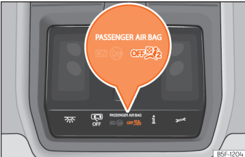
Şek. 21 Tavan konsolunda: ön yolcu ön hava yastığının devre dışı bırakılması için kontrol lambası.
