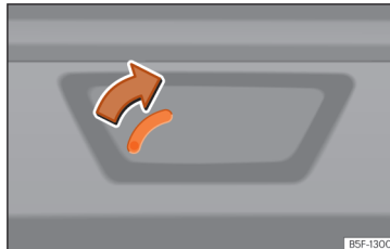
Şek. 97 Bagaj bölmesinin ayrıntıları: manuel serbest bırakma mekanizması (Leon Sportstourer).
